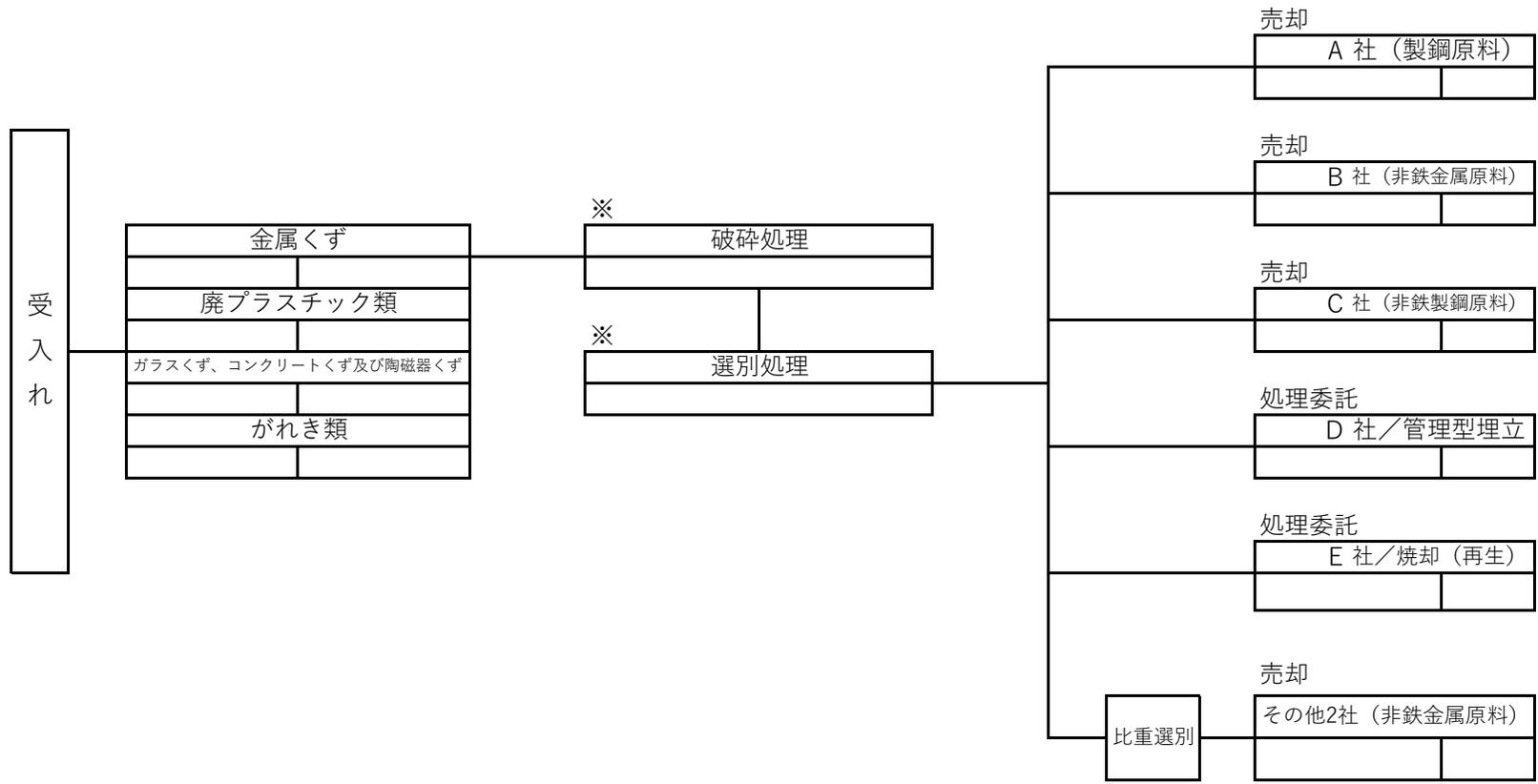
※那須事業所では破碎処理の後、一連のラインで全量が選別にかかるため、処理量は破碎・選別とも同量となる。
