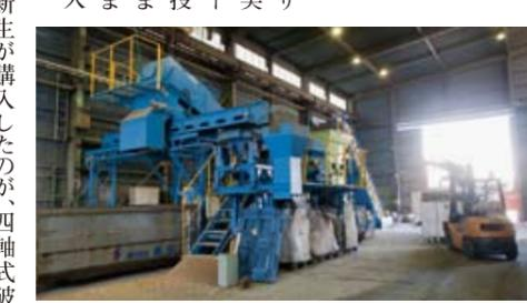
(株)新生が導入した四軸式破碎機。一軸式カッターの従来機に比べ、パワーと耐久性が格段に向上しました。
