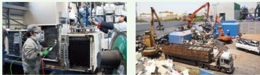
家電リサイクル法が定める4品目すべてのリサイクル処理を実施しています。フロン回収装置によるフロン回収、手作業によるリサイクル可能パーツの取り外しが行なわれた後、シュレッダーヤードへ搬出し、破砕処理を行います。
