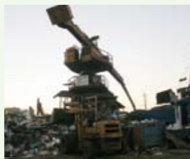
解体を終えた車両をプレシュレッダー、シュレッダーで細かく破砕。破砕後のミックスメタルは、鉄、非鉄、ダストに分類され、リサイクルされます。
