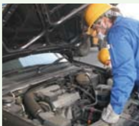
車体からタイヤやバッテリー、エアバッグを取り外し、フロンガス、冷却水、パワステオイル、燃料などを回収します。
