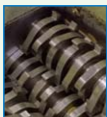
カッター部分 投入された材料を、4本のカッターを回転させて切り刻みます。一軸式に比べ、パワーと耐久性に優れ、広範囲の材料を破砕することが可能です。
