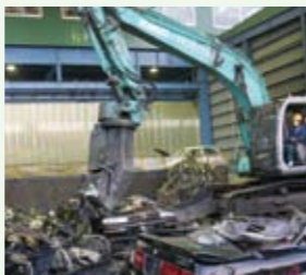
エンジンやドアなど、リユースできそうなパーツを手解体で回収。その後、大型の重機で解体します。
