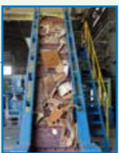
ベルトコンベア 重機で投入された材料はベルトコンベアでカッター投入口まで運ばれます。
