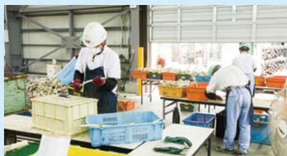
家電手解体工程には2014年6月現在、10名が配備されており、主に空気清浄機の解体作業を行なっている。
