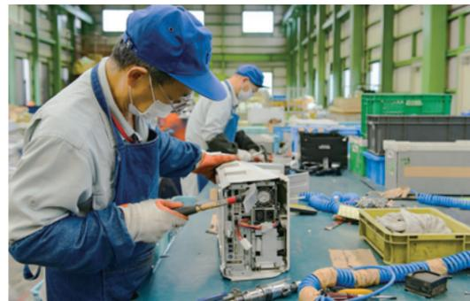
OA機器など1台ずつ人の手で解体。パーツごとに仕分け。基板については不純物を取り外し品位向上を図る。迅速で丁寧な熟練の作業。
