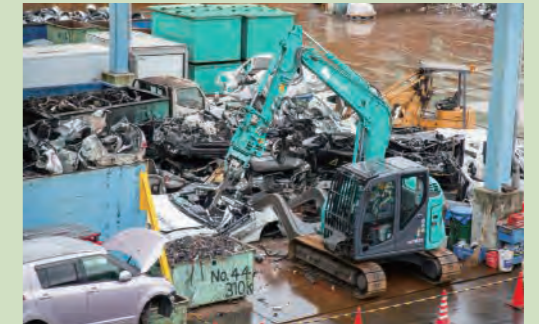
小型ニブラで自動車から再生資源を取り出している様子
