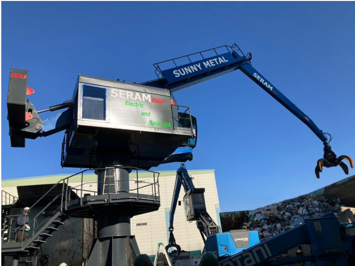
今回導入した SERAM 社製の電動式タワークレーン
